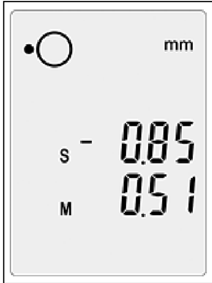
รูปที่ 16 หน้าจอจะบอกให้หมุนไปที่ตำแหน่ง 9 นาฬิกา
